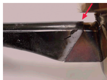
写真6 崩れかけたフェノール樹脂
